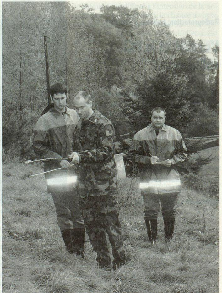
Recherche d'une source radioactive à l'aide du IC90.
