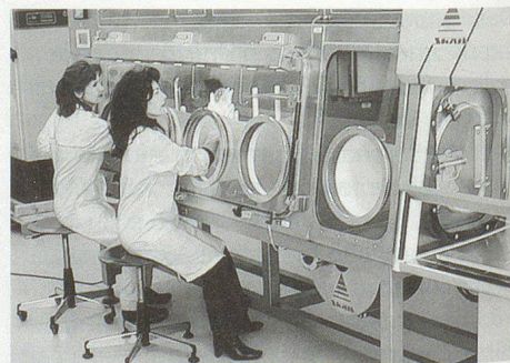
Attualmente, il Laboratorio Spiez dispone di un glove-box che garantisce un grado di sicurezza 3 per il personale del laboratorio. Questo impianto permette ad esempio di esaminare campioni sospetti che potrebbero contenere antrace.
