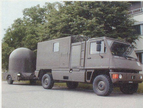
P-763+: die mobilen Elemente zum Start von Wetterballonen bei der Artillerie.
