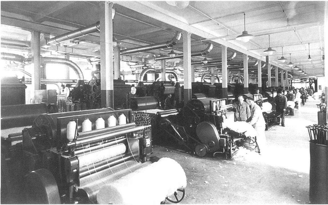
Abb. 8 Die Battage-Abteilung um 1945. Die Maschinen lösten die Baumwolle in Flocken auf, reinigten und mischten sie. Aus den Batteuren kam der Wickel heraus, ein Baumwollflies, das auf Rollen aufgewickelt wurde, bevor man es in der Karderie weiter verarbeitete.
