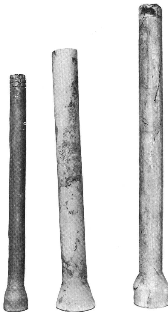
Abb. 12 Maschinell gepresste Tonröhren (85/111/94 cm lang) ZMM Reg.- Nr. 1786.1, 1804, 1805)
