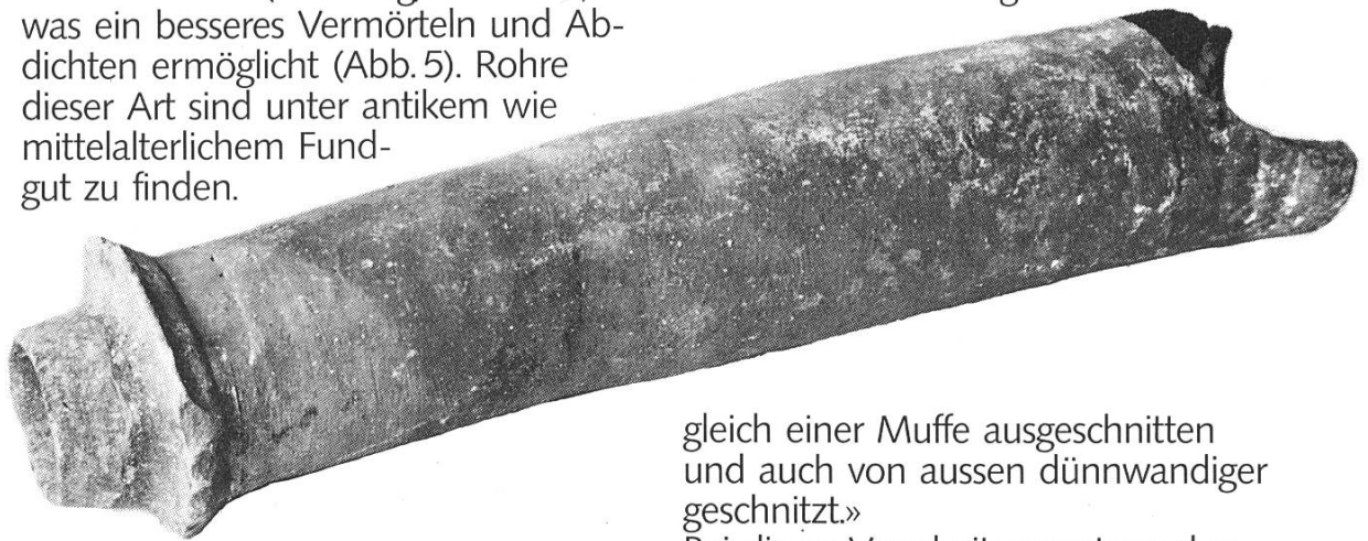
Abb. 5 Auf der Scheibe gedrehtes Rohr mit Flansch (Schweiz. Landesmuseum Zürich, LM 18127)
