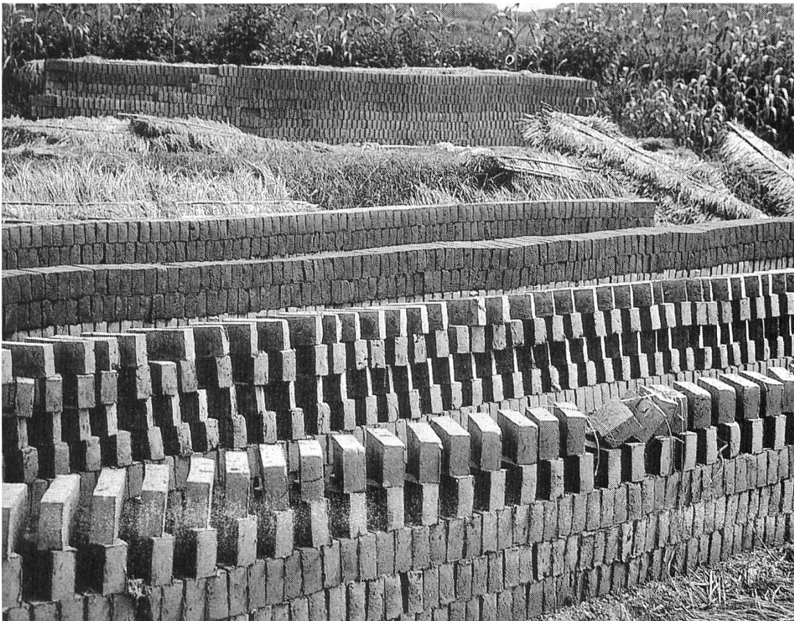
Abb. 4 Backstein- stapel werden an der Sonne getrocknet
