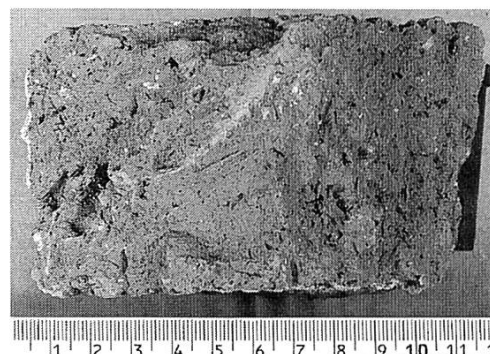
Abb. 5 + 6 Schwieber- dingen, Bruchstück eines Leicht- backsteines, Aufsicht und Querschnitt.
