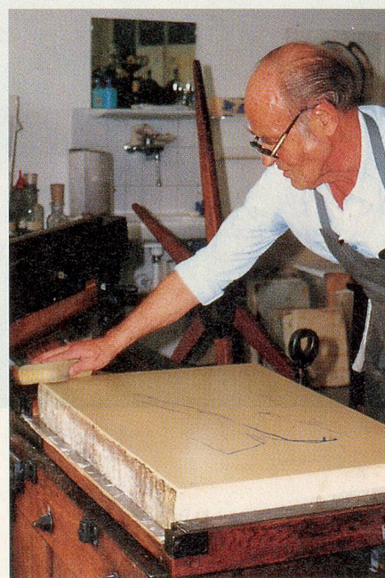
Bevor die Farbe eingewalzt werden kann, befeuchtet Willi Steinauer den Stein mit einem nassen Schwamm.
