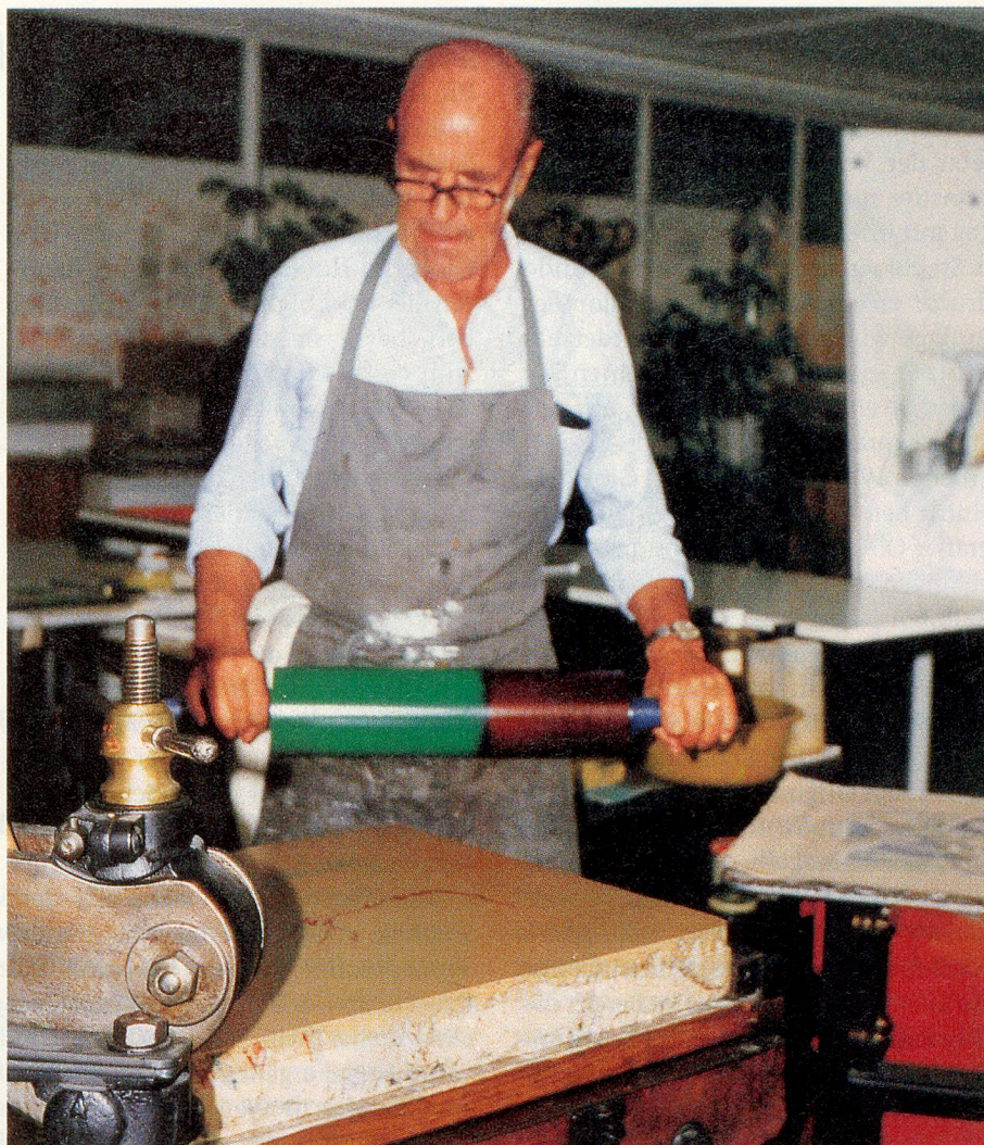
Beim Irisdruck werden mehrere Farben gleichzeitig aufgetragen.
