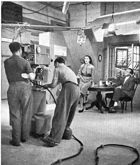
Fernsehaufnahme aus Zürich. Chefkameramann Roetheli an der Arbeit. Oben der Tonarm mit dem Mikrofon. Auffallend, die im Verhältnis zu Filmaufnahmen geringe Beleuchtung. Fernsehkameras sind viel lichtempfindlicher als Filmkameras. (Photo G. Züst.)
