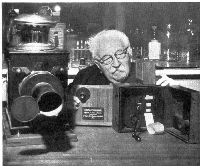
August Lumière vor dem ersten Kinematographen, den er zusammen mit seinem Bruder Louis 1894 erbaute. Er diente sowohl als Projektor wie als Aufnahme- und Entwicklungsapparat.
