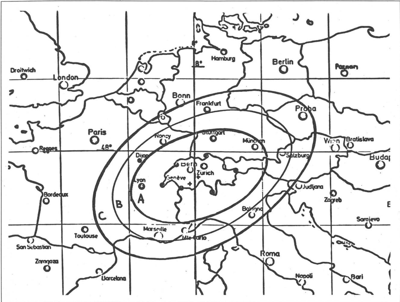
An der internationalen Wellenkonferenz in Genf erhielt die Schweiz drei Bereiche mit elliptischem Querschnitt zugesprochen. Dauernd mit einem genügenden Signal bedeckt wird vor allem die Nutzellipse A. Mit grösseren Parabolantennen von Gemeinschaftsanlagen kann der Empfang auch noch innerhalb der Ellipse C sichergestellt werden.
