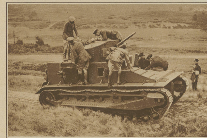
Abrüstung? Ein neuer, mit Geschützen und Maschinengewehren armerter amerikanischer Tank, der sich mit einer Stundengeschwindigkeit von 60 km fortbewegen kann. Phot. Central News
