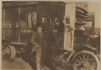
Ein überfalliger amerikanischer Postautomobil. Die vielen Überfälle auf die Posten haben die amerikanischen Post-Departement zur Anschaffung einer Anzahl besonders konstruierter Automobils veranlaßt, deren Verstecke mit schließbaren, durchsichtigen Schichten versehen sind, deren Seitenwände mit Stahl gepanzt sind
