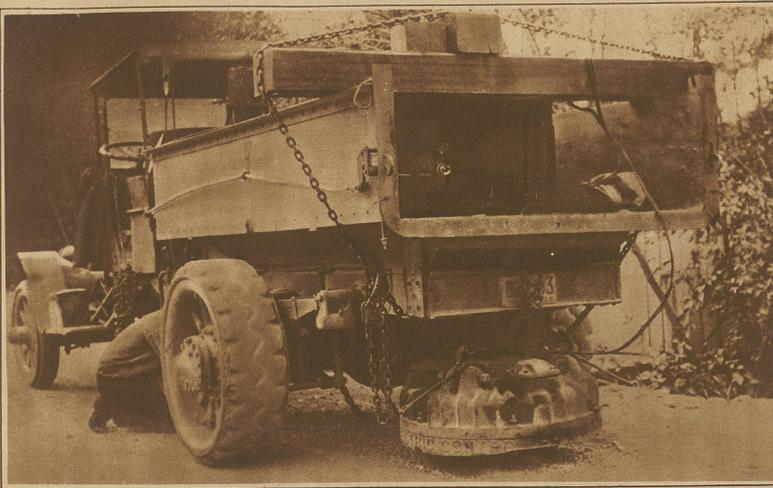
Magnetische Reinigung von Automobilstraßen. In Amerika werden zur Reinigung von Automobilstraßen große Lantankos, unter denen ein Riesenmagnet angebracht ist, verwendet. Der Magnet besitzt ungefähr 250 Volt und zieht sämtliche Eisenteile, Nägel usw. im Umkreis von einem Meter an. Unser Bild zeigt das Magnet-Straßenreinigungs-Auto im Betrieb
