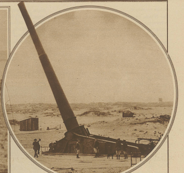
Die größte Kanone der Welt befindet sich im Fort Tilden bei New York und dient zur Küstenschutz. Die Feder des Geschützes misst 12 Zoll und das Geschütz ist imstande, Geschosse von 34 Zentnern Geschosse abzufeuern
