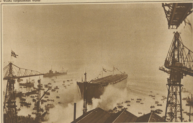
Der Stapellauf des größten italienischen Ueberseeschiffes „Roma“. Am 26. Februar liegt in Sestri Ponente bei Genua das größte italienische Ueberseeschiff von Stapel. Der Dampfer ist 213 Meter lang, hat 23.000 Tonnen Wasserverdrängung und eine Geschwindigkeit von 23 englischen Meilen.
