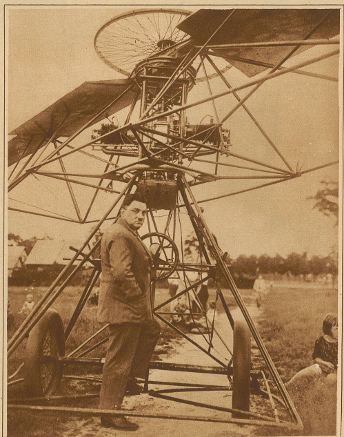
Engelbert Zaschka, ein deutscher Ingenieur, hat ein Hubschraubenflugzeug konstruiert, das horizontal sein soll, vertikal aufsteigen, in der Luft stillstehen und wieder senkrecht zu landen. Wichtig ist ferner, daß es dem Erfinder geglückt zu sein scheint in der Luft völlige Stabilität und auch ein Gleitvermögen des Flugzeuges zu erreichen. Unser Bild zeigt Ing. Zaschka mit seinem Apparat auf dem Fluggelände Jochensthal
