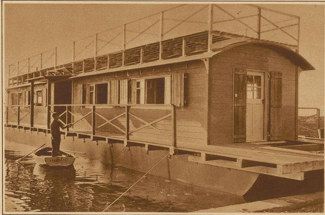
Das von einem Genfer Sportsmann gebaute schwimmende Haus, das eine Länge von 24 m hat und mit einem 18 P.S.-Motor versehen ist
