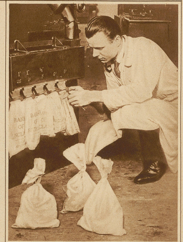
Auf der Rückseite der Maschine fällt das abgezählte Geld in kleine Säcke
