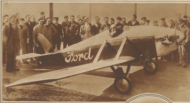
Das kleine Fordflugzeug. Henry Ford hat beigeiten erkannt, daß an Stelle seines kleinen Fordwagens einst das Flugzeug treten muß und er fängt daher heute schon an, sich darauf umzustellen. Ein solches Flugzeug, das bereits den Dauerrekord für Kleinflugzeuge gebrochen hat, wiegt nur 5 Zentner, hat einen 30 PS-Motor und entwickelt eine Durchschnittsgeschwindigkeit von 100 Meilen in der Stunde. Rechts: Ivan Zoukowsky, ein früherer russischer Fürst am Zarenhofe, kam nach der Revolution nach Frankreich. In einem großen Restaurant der Grand Opera in Paris hat er die Stellung des Oberkuchens inne und produziert sich gleichzeitig zuweilen als Amateur-Accrobatis. Er scheint noch ein adeliges Geblüt zu besitzen, denn er vermag mit seinen Zähnen drei Tische zu halten.
