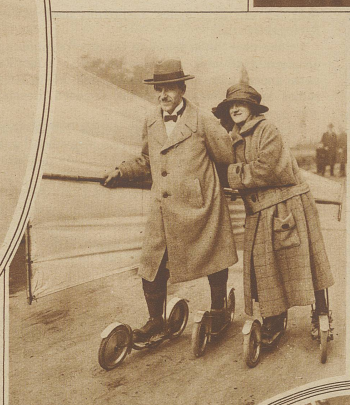
Unteres Bild: Ein neuerlicher Verkehrs- und Sportrollschuh, der nach einiger Übung rasche Fortbewegung er- laubt. Bei windigem Wetter kann auf offener Strecke mit Vorteil ein Handsegl zum Antrieb ver- wendet werden
