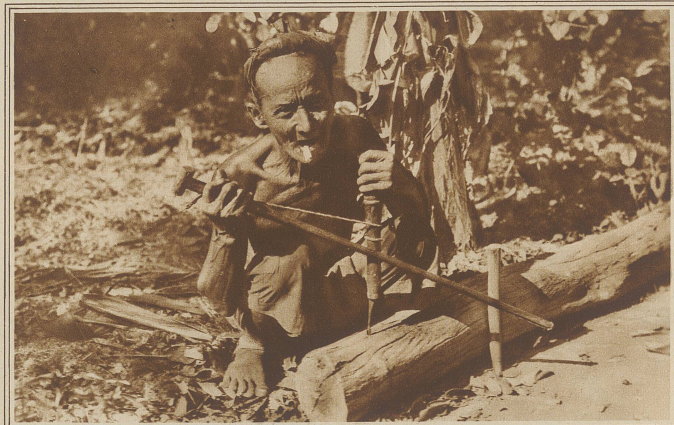
Cochinchina. Anamitischer Zimmermann mit seiner primitiven Bohrmaschine. Durch das Hin- und Herziehen des Stockes wird der mit der Sehne unwidderliche Bohrer erstaunlich rasch in das Holz getrieben
