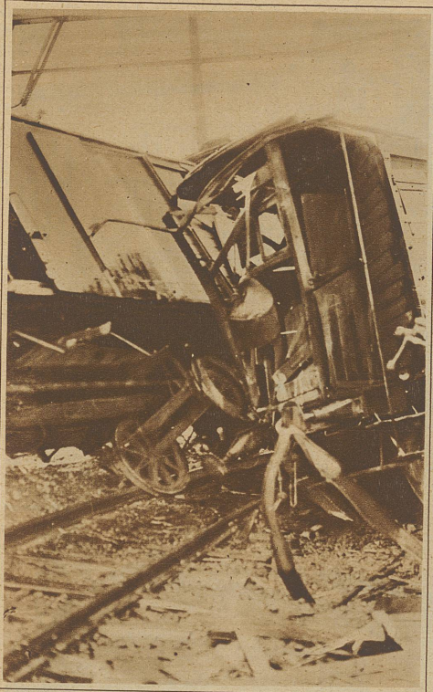
Zugsentgleisung im Bahnhof Wollishofen. Am Donnerstag früh entgleiste auf der Station Wollishofen bei der Einfahrtsweiche ein Güterzug aus der Richtung Zürich. Außer der Lokomotive wurden 15 Wagen aus dem Geleise geworfen, wovon vier völlig ineinandergeschoben und zertrümmert wurden. Personen wurden keine verletzt, denn auch der Zugführer, der sich im Moment der Entgleisung auf dem Bremssitz eines völlig zertrümmerten Wagens befand, kam wie durch ein Wunder ohne die geringste Verletzung davon. Degegen ist der Materialschaden bedeutend
