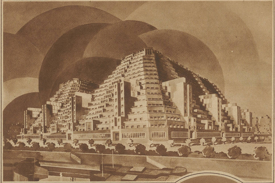
Neues Bauen. Ein ganz originelles Projekt des modernen Städtebaues hat der französische Architekt Henri Sau- vage entworfen. Die einzelnen Stock- werke sind treppenförmig überein- ander gebaut, so daß die Gebäude- komplexe das Aussehen ägyptischer Pyramiden erhalten
