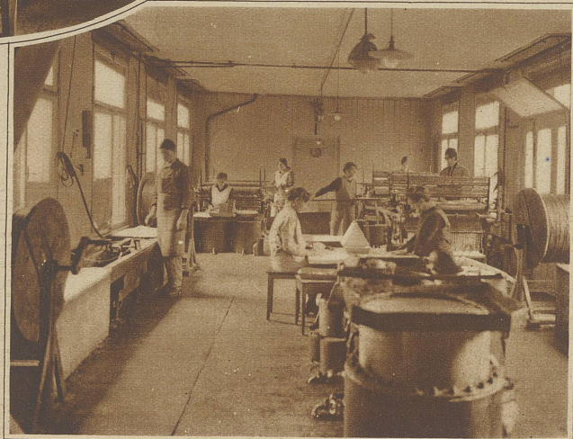
Bild links: Kerzengießmaschinen. Ziehen, Gießen und Stutzen von Weihnachtskerzen — Foto: Lienhardt
