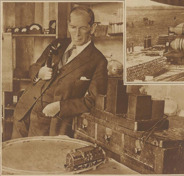
Bild links: Eine Lokomotive, die der menschlichen Stimme gehorcht, ist vom New-Yorker Ingenieur M. Jones erfunden worden. Die kleine Lokomotive der Modellbahn reagiert sofort entsprechend auf die ins Mikrophon gesprochenen Anrufe, wie «vorwärts - halt - rückwärts»
