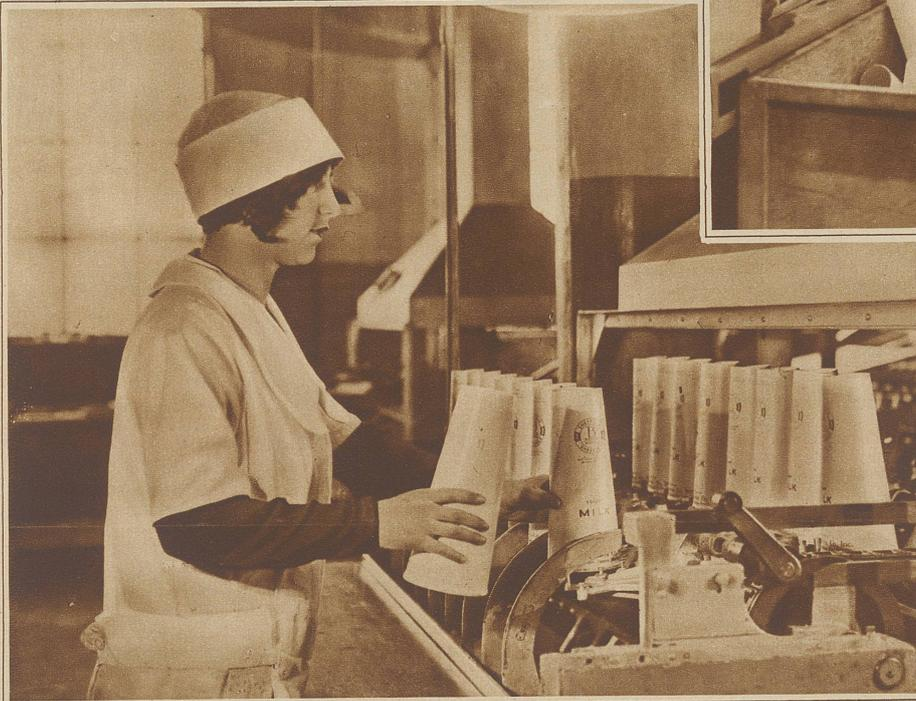
Sterilisierung durch ein Paraffinbad mit anschließender Luftkühlung
