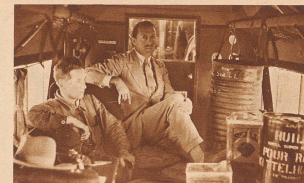
In der Luft zwischen Reggan und Gao. Um Sandstürmen und Gegenwinden gewachsen zu sein, haben wir noch vier Fässer Benzin in die Kabine hineingegenommen. Kapitän Wood und Mechaniker Wegmann pumpen es in die oberen Flügeltraktoren. Die Luft ist dünn, es ist schwer, die Flughöhe zu bestimmen und die Horizontale ohne Instrumente genau einzuhalten.
