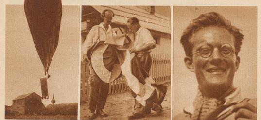
Der Ballon Piccards, mit dem ihm der Stratosphärenflug glücklich gelang, kurz nach dem Start in Augsburg. Der Ballon ist nur zum Teil mit Gas gefüllt. Erst in großer Höhe wird er durch die Ausdehnung des Gases Kugelform annehmen. Die Flagge trägt das schweizerische Zeichen CH.
