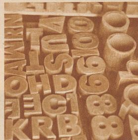
Buchstaben in Terrakotta, von Prof. Zutt entworfen, werden von den Arbeitslosen mit derselben Leichtigkeit ausgepreßt, wie die Mutter ihre Formen in den Gutzliège drückt. Die Buchstaben finden als billiger Ersatz für Blechbuchstaben in der Reklame Verwendung
