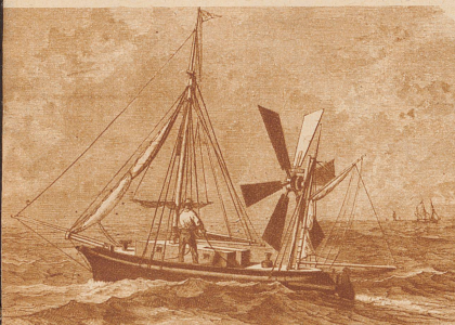
Windmühlenschiff. Das Windmühlensrad sollte zum Antrieb der Schiffsschraube dienen. Vom Gegenwind dadurch unabhängig, suchten zwei Engländer im Jahre 1870 auf dem kleinen Segelboot von Europa nach Amerika zu gelangen. Sie blieben verschollen.
