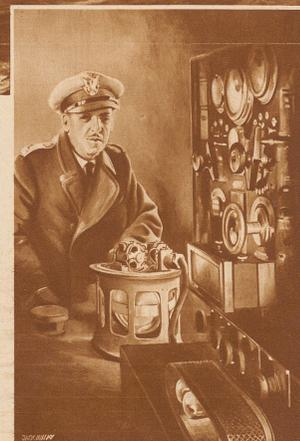
Empfänger (rechts) mit Steuerkreisler (Mitte) eines ferngesteuerten Schiffes
