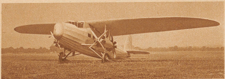
Ein neuer Dornier. Auf dem Flugplatz Dübendorf wurde vergangene Woche das neue Dornier-Verkehrsflugzeug Do K vorgeführt. Dieser Do K ist ein freitragender Eindecker mit den respektablen Ausmaßen von 25 m Spannweite und 16,65 m Länge. Er bietet 10 Personen Platz und hat eine Reisegeschwindigkeit von 200 km in der Stunde. Zum Antrieb dienen vier 220 PS-Motoren, aber auch zwei Motoren genügen, um ihn in der Luft zu halten
