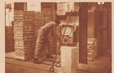
Das aus den Schmelzöfen kommende flüssige Metall wird in kleinen Gefäßen zu Barren gegossen, die man Masseln nennt. Die erkalteten Masseln kommen hernach in einen Umschmelzofen, wie das Bild zeigt. Aus diesem Ofen erst wird das Metall in genügender Einheitlichkeit gewonnen
