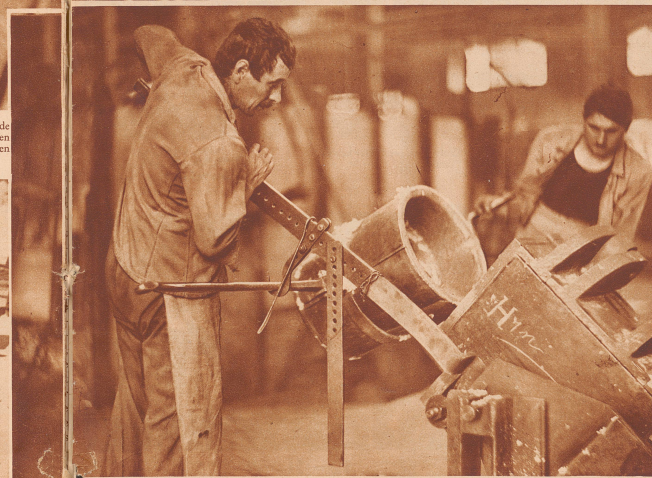
Aus dem Umschmelzofen geschöpftes Metall wird hier mittelst einer kippbaren Kokille zu schweren Walzbarren gegossen
