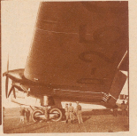
Allen an dieser Junkersmaschine «G 38» an. Preisgeld. Ihre Spannweite beträgt 44 Meter, die Spannweite der menschlichen Konkurrenz nur 18 Meter. Es flog 10 Passagiere und eine Besatzung von 6 Mann. Die Motoren sind in die Flügel eingebaut.
