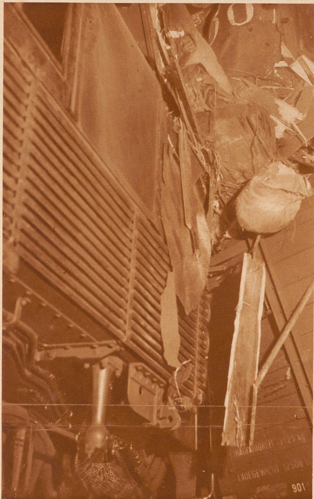
Die Gotthardlokomotive und der darauffolgende Schutzwagen, der Wagen also, der immer zwischen Lokomotive und erstem Personenwagen bei jedem Zug eingeschaltet wird
