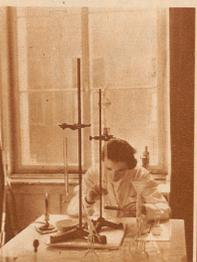
Die Untersuchung des Blutdestillates erfolgt zweifach. Dieses Bild zeigt die chemische Untersuchung vermittels einer Titrationsmethode
