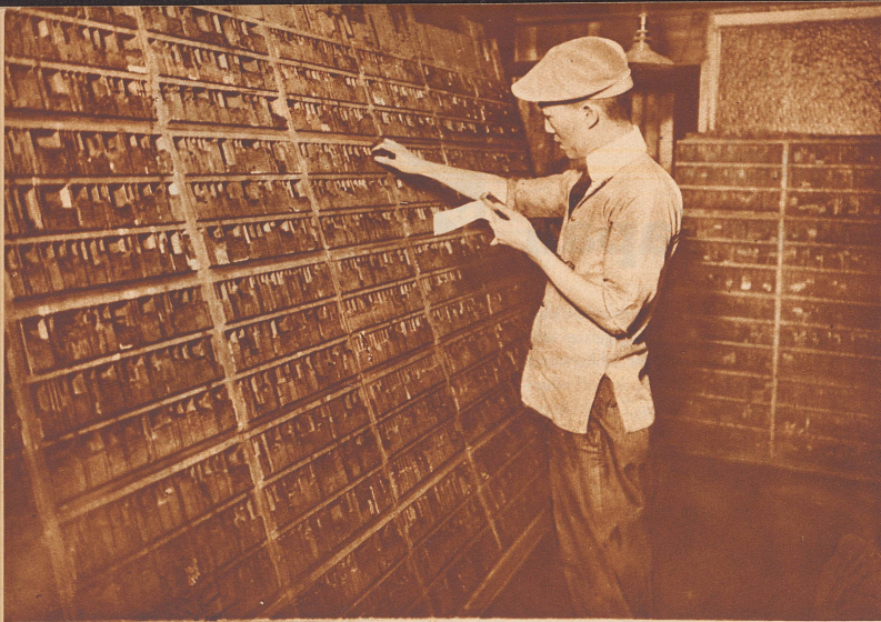
Der Setzer chinesischer Schrift. Er hat nicht einen Setzkasten vor sich, wie die Setzer unserer Schriften, sondern sozusagen eine ganze Setzwand. Tausende von Zeichen. Es gibt wegen der vielen Zeichen keine Setzmaschine für chinesische Schrift.
