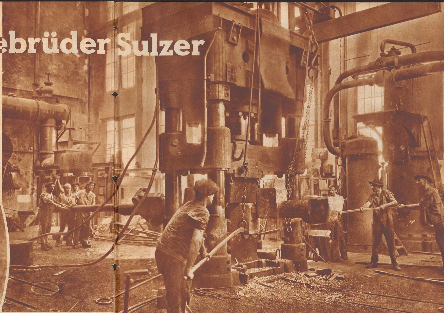
Aus den Sulzer-Werkstätten in Winterthur. Hydraulische Schmiehpresse von 1000 Tonnen Druck, zum Schmieden von Kurbelwellen und andern großen Stücken
