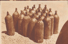
In diesen Stundentfässern mit 34,5 kg Inhalt gelangt das Quecksilber auf den Markt.
