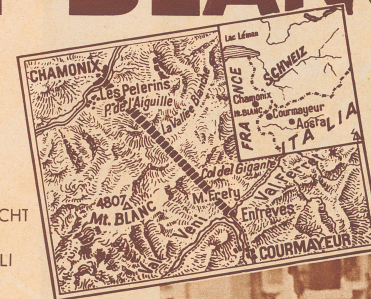
Karte vom Mont-Blanc-Gebiet mit der eingezeichneten geraden 12,5 Kilometer langen Tunnelverbindung vom französischen Chamonixital ins italienische Val Ferret.
