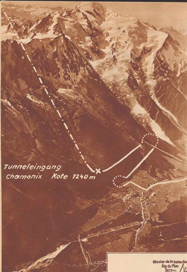
Fliegeraufnahme von Chamonix mit dem Mont-Blanc. Die eingezeichnete kompakte Linie ist projektierte Zufahrtsstraße zum Mont-Blanc-Tunnel, die beiden punktierten Bögen sind Kehrtunnels der Zufahrtsrampe, die große Strichpunktlinie der Tunnel durch den Mont-Blanc. Das Kreuz bezeichnet die Stelle, wo auf 1240 Meter Höhe der Tunnel beginnt. Das Dorf Chamonix liegt 1041 Meter über Meer.
