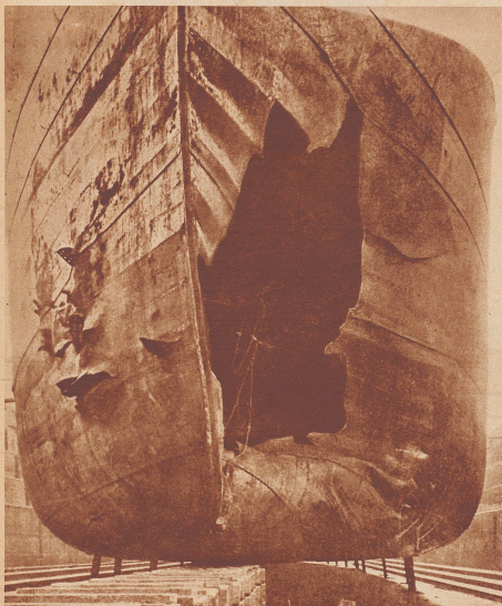
Ein Beispiel dafür, daß nicht jeder Torpedo tödlich wirkt. Dieser große norwegische Tankdampfer «Belridge», mit einer Ladung Erdöl an Bord, wurde auf der Fahrt von England nach Frankreich von einem deutschen Unterseeboot angegriffen. Der Torpedo traf den Bug. Die Sprengwirkung war furchtbar, aber die sorgfältige Innenkonstruktion des Schiffes, seine doppelten Wände und die Torpedoschotten, verhinderten das Sinken. Der schwer havarierte Dampfer konnte einen Hafen erreichen, im Trockendock geschleppt und wieder flottgemacht werden.
