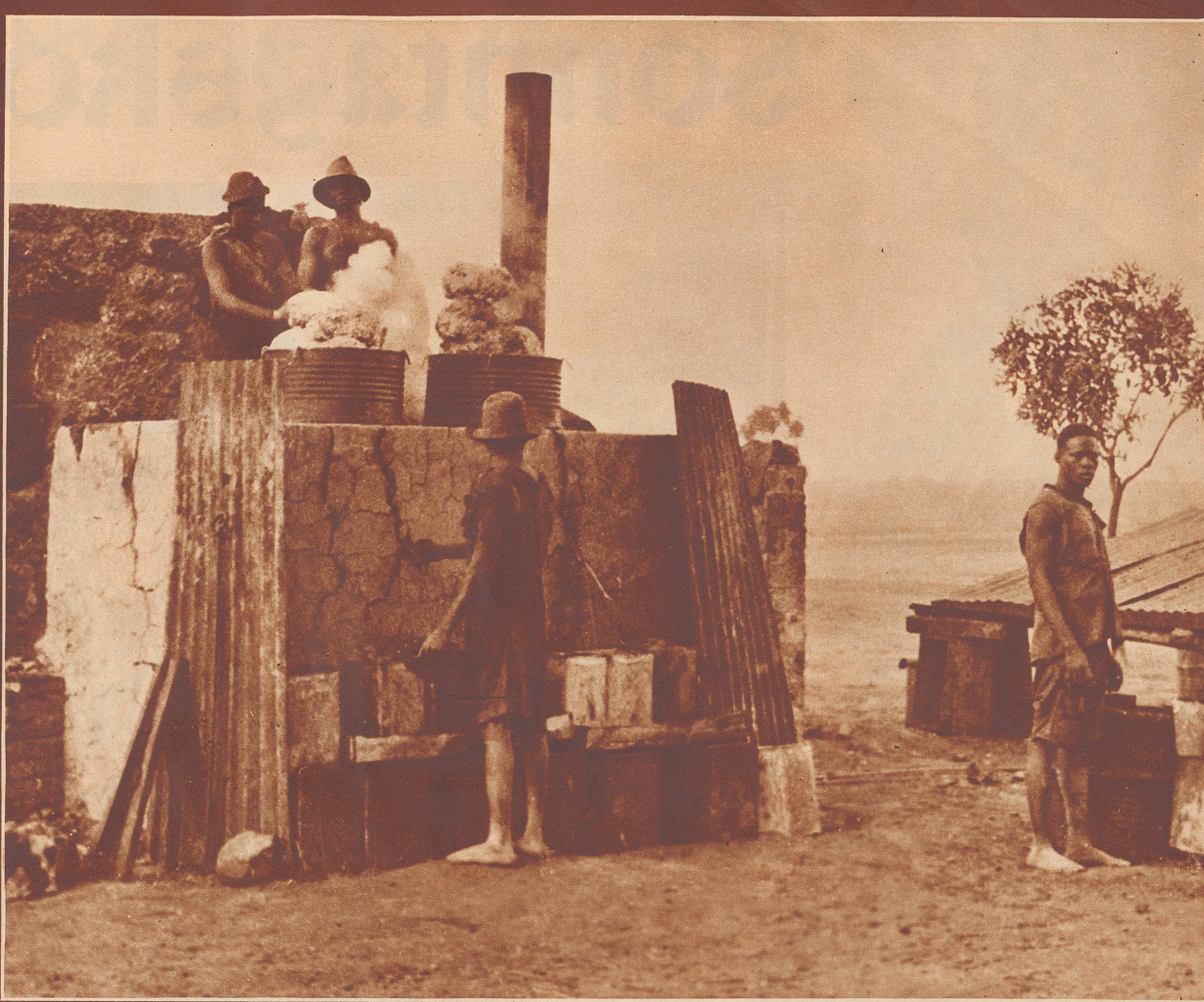
Schmelzofenanlage zur Gewinnung von Palmbutter an der Elfenbeinküste. Alles ist sehr primitiv eingerichtet. In eisernen Kesseln werden die gerösteten, zu Ballen gepressten Palmenkerne zum Schmelzen gebracht. Die durch dünne Rohre abfließende Palmbutter wird in alte Benzinkannen gefaßt und nachher in transportfähige Eisenfässer abgefüllt.
