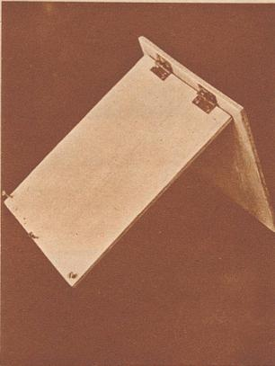
Wenn ihr nun noch die Rückwand mit den beiden Seitenteilen und dem Boden zusammenschraubt, ist das Futterhäuschen fertig. Es wird etwas solider, wenn wir das Dach mit Zinkblech verkleiden. Wenn man nicht fleißig Futter nachschütten will oder kann, ist es von Vorteil, wie in dem abgebildeten Modell, ein Glas einzufügen, wozu ihr vor dem Zusammenfügen ca. 1 cm vom Rand entfernt eine Rille anbringen müßt, die euch natürlich gerne jeder Schreiner macht, sofern ihr nicht das nötige Werkzeug besitzt.
