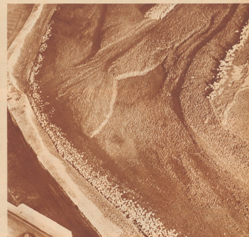
Die Ausbagger der Flußläufe des Modells erfolgt von Hand mit Hilfe einer Kelle. In den berechneten großen Gefällen werden die ausgebaggerten Mengen genau gemessen.
