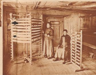
Beim Zetteln in der Bauernstube laufen die Fäden vom Spinnrad durch das Zettelblech zu Hand einer Bäuerin, die gleichzeitig den Zettelrahmen dreht.
