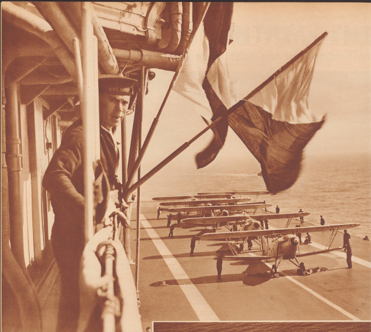
Sechs Flugzeuge auf dem Flugdeck des «Courageux» warten auf das Startzeichen des Signalhebers, um in Intervallen von 15 Sekunden zu starten.
