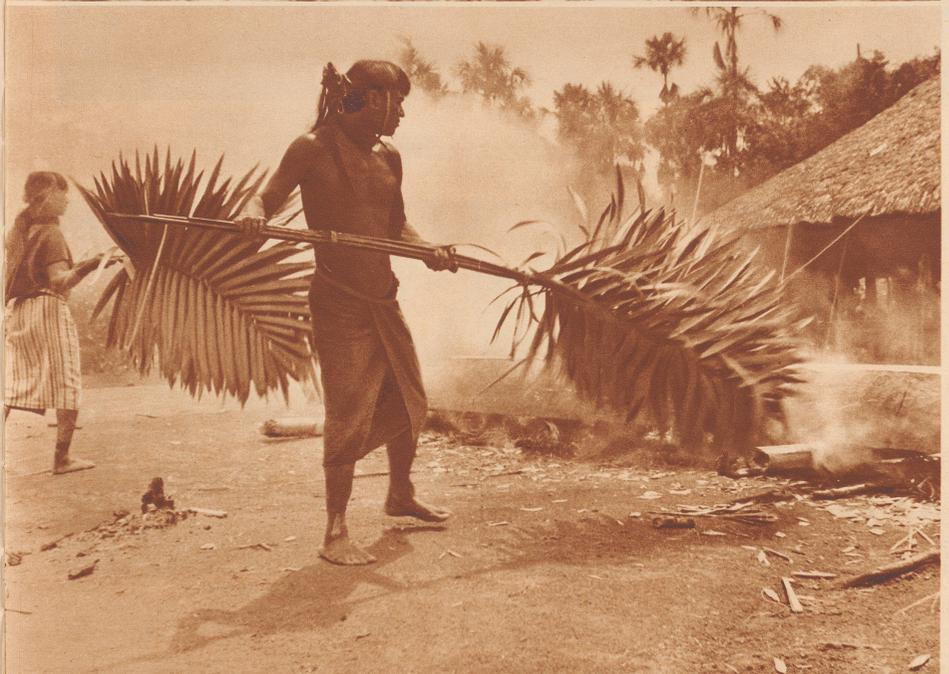
Jivaroindianer beim Bootbau. Nach Fertigstellung der äußeren Form des Bootes wird der Einbaum im Innern ausgebrannt. Mit einem Palmwedel facht der Jivaro den Feuer an.
