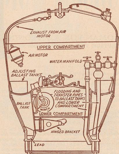
Querschnitt durch die Taucherglocke
