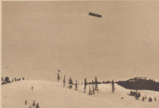
Das Ziel der von einem Flugzeug nachgezogene Schleppack. Es wird an einem Stahlkabel von 600—1200 Meter Länge nachgezogen, um Flugzeug und Pilot außerhalb der Gefahrenzone zu halten.
